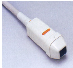
Figura 20: Sonda convex. Su morfología es curva y la imagen tiene forma de abanico. Su uso es múltiple y versátil, habitualmente con frecuencias bajas e intermedias.
